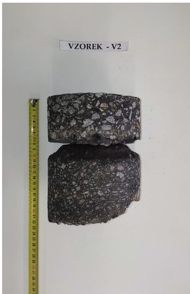
Obr. 4 - Jádru vývrtu Vzorek – V2 (laboratoř).
