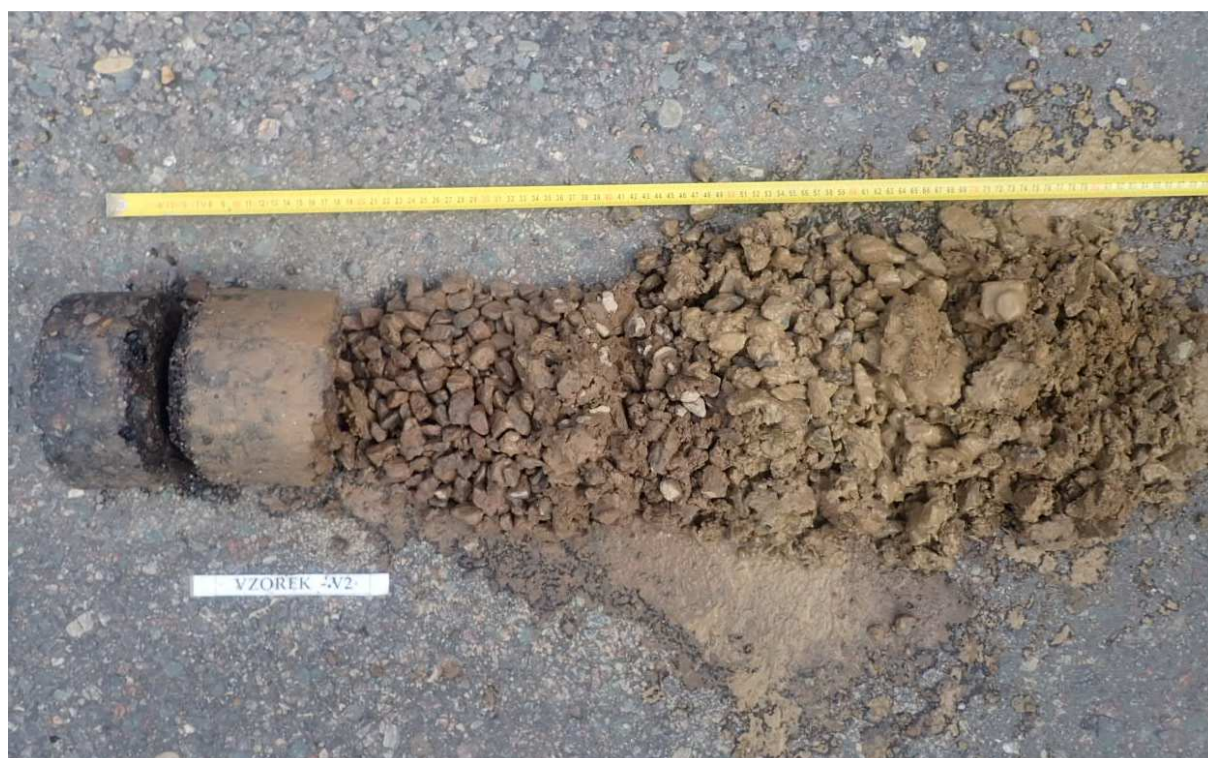
Obr. 3 - Jádro vývrtu Vzorek – V2 (in situ).
